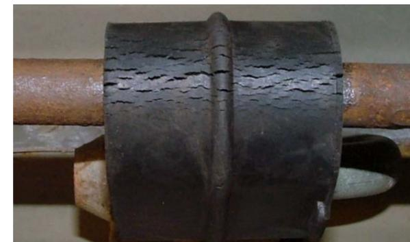
Beim herkömmlichen Produkt sind bereits erste Risse an der Oberfläche sichtbar und das Gummi ist von ca. 58 auf 70 Shore (A) ausgehärtet. Das führt unweigerlich zu Nebengeräuschen.
