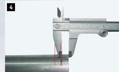
4 Anschlussrohr ca. 10 mm tief in das neue Flexrohr einschieben und dann verschweißen.
