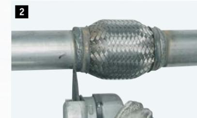
2 An der gekennzeichneten Stelle (hinter der Schweißnaht) altes Flexrohr mit der Flex abtrennen.
