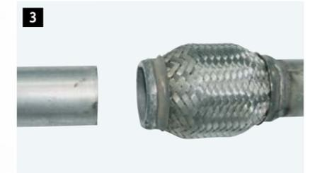
3 Altes Flexrohr entfernen.
