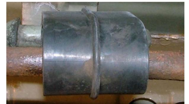
Beim Gummiformteil aus EPDM sind keine optischen Schäden vorhanden und die Gummihärte beträgt dauerhaft 52 Shore (A).
