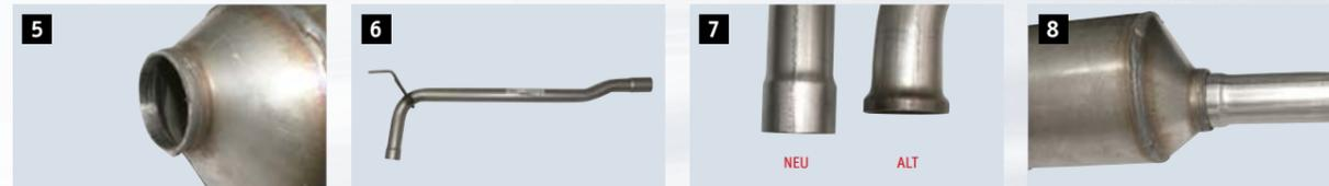
**5** Wenn Öffnung am Konus gereinigt ist (alle Reste vom alten Rohr müssen entfernt sein), kann das neue Reparaturrohr problemlos eingeschoben werden.
