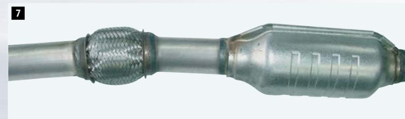
7 Clevere Reparaturlösung: Neues Flexrohr am alten Bauteil.
