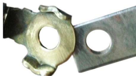
Фиг. 2: Връзка към корпуса след почистване: добър контакт
