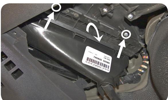
**IT** Allentare le viti che trattengono la copertura stessa. Rimuovere la copertura della camera filtrante
