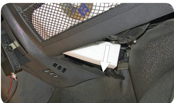
**IT** Cambiare il filtro assicurandosi di posizionare saldamente il nuovo filtro nella guida della camera filtrante
