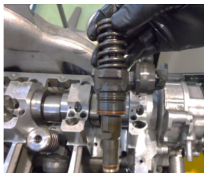
Aflojar tornillo de la placa de sujeción del inyector-bomba.
