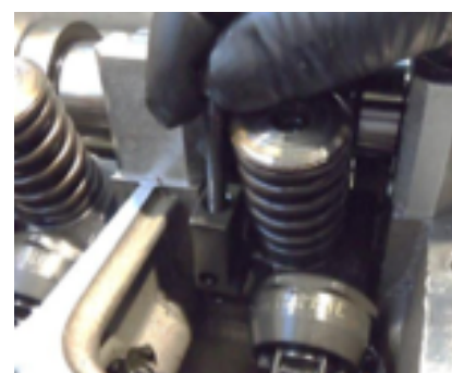
Retirar placa de sujeción del inyector-bomba.
