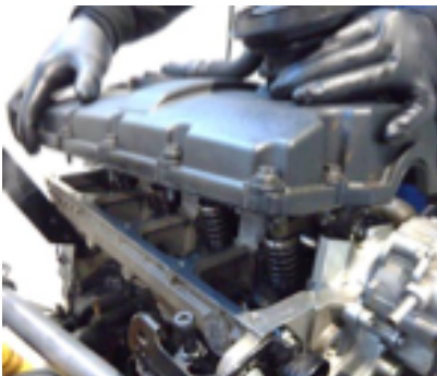
Levantar la tapa de culata.
