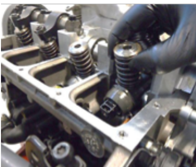
Extraer el inyector-bomba tirando hacia arriba
