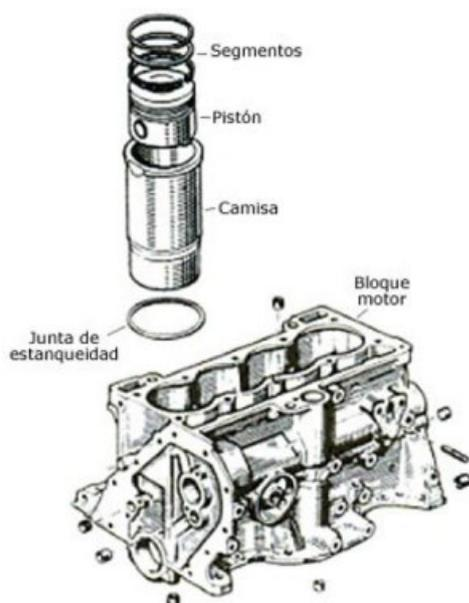
Para montar las camisas húmedas en el bloque es necesario ajustarlas por medio de unas juntas de estanqueidad, que evitan que el agua pase al cárter de aceite.
