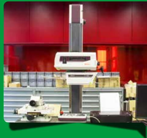
● Asimismo, el know how y los instrumentos específicos de medición nos permiten comprobar, en la fase de suministro, los cojinetes y su constante conformidad con los estándares, además de aportar los cambios necesarios para mejorar sus características.
