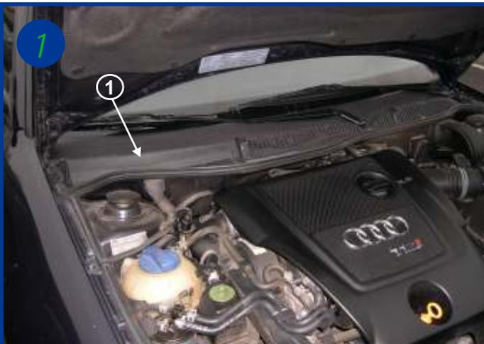
L'élément filtrant est situé coté passager sous le capot moteur sur la baie de pare brise (voir flèche 1). Ouvrir le capot moteur.
