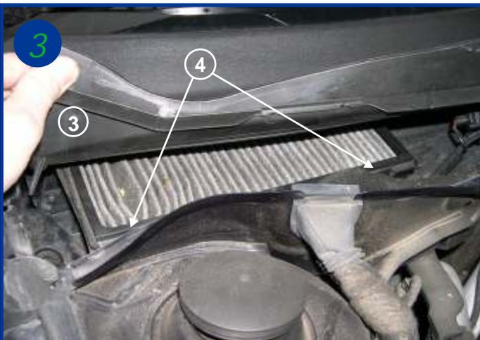
Déclipper l'élément filtrant et son cadre (flèche 4) en maintenant ouvert le volet (3).
