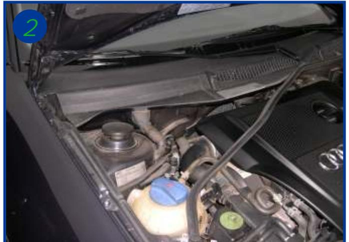
Dégager sur la moitié le joint d'étanchéité moteur (flèche 2)
