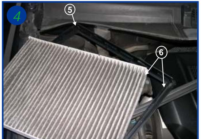
Extraire l'élément filtrant usagé de son cadre (flèche 5). Le remplacer en veillant à ce que les deux premiers plis aux extrémités du filtre soient engagés dans les bordures prévues à cet effet (voir flèche 6). Le remontage s'effectue dans l'ordre inverse du démontage
