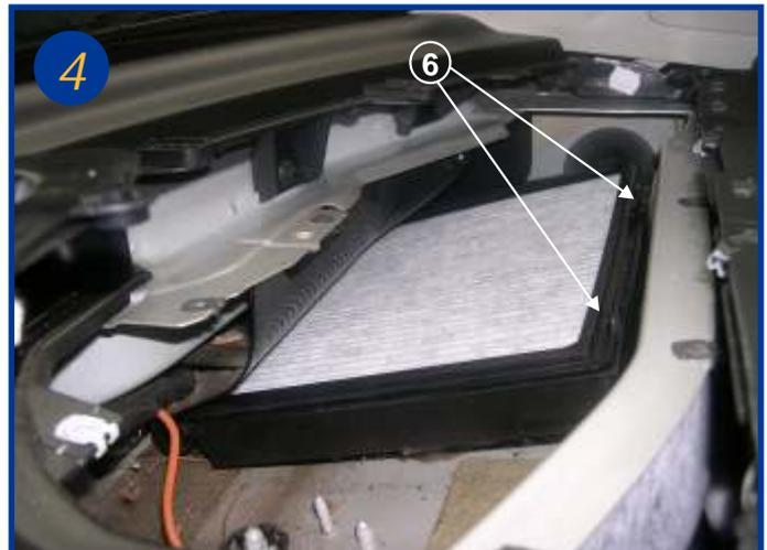
Dégager l'élément filtrant de son cadre en actionnant les 2 pattes de fixation (flèche 6) et le remplacer.
