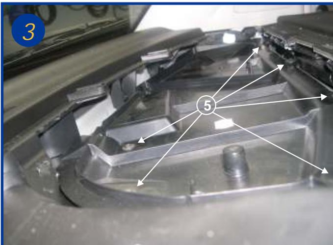
Dévisser les 6 vis de fixation du cache plastique (voir flèche 5) et retirer ce cache.
