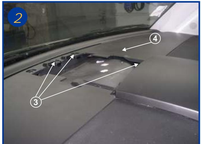
Dévisser les 3 vis de fixation du plastron plastique coté droit (voir flèche 3). Retirer le plastron dans le sens de la flèche 4
