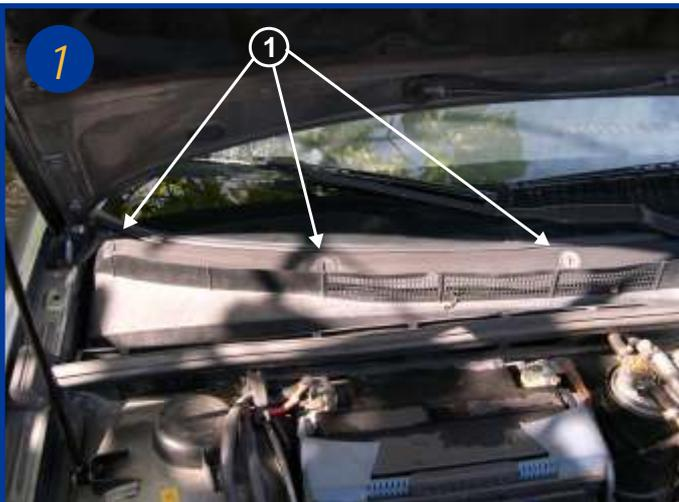
L'élément filtrant est situé sous le capot moteur sous la baie du pare brise côté passager.
