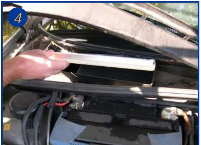
Replacer le nouvel élément filtrant en le positionnant dans le fond du boîtier et l'encliqueter à l'aide des 4 ergots placés aux 2 extrémités de l'élément. Le remontage s'effectue dans l'ordre inverse du démontage.
