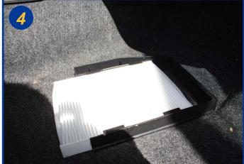
Retirer I 'élément du cadre amovible et le remplacer, en le faisant coulisser dans le sens de la flèche. Le remontage s 'effectue dans I 'ordre inverse du démontage. Il est possible de se procurer le cadre avec son élément.
