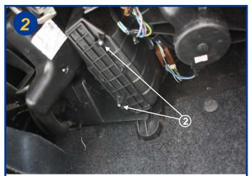
Dévisser les 2 vis torx du couvercle du boitier filtrant et retirez-le (2).
