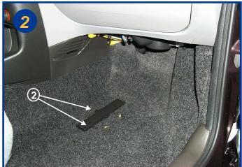
Retirer le couvercle du boitier filtrant après avoir dévissé les 2 vis de fixation de ce couvercle (voir flèche 2).
