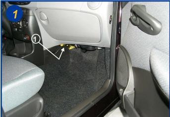
L'élément filtrant est situé sous la boîte à gants dans l'habitacle du véhicule coté passager (voir flèche 1). Ouvrir la portière avant droite.
