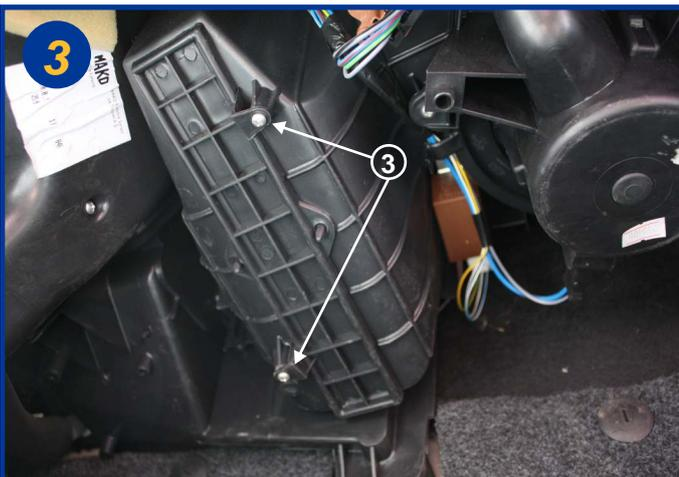
Dévisser les 2 vis cruciformes (3) et retirer la trappe du boîtier filtrant.
