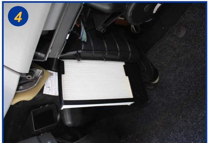
Retirer le cadre et son élément filtrant et procéder à son remplacement. Le remontage s'effectue dans l'ordre inverse du démontage.
