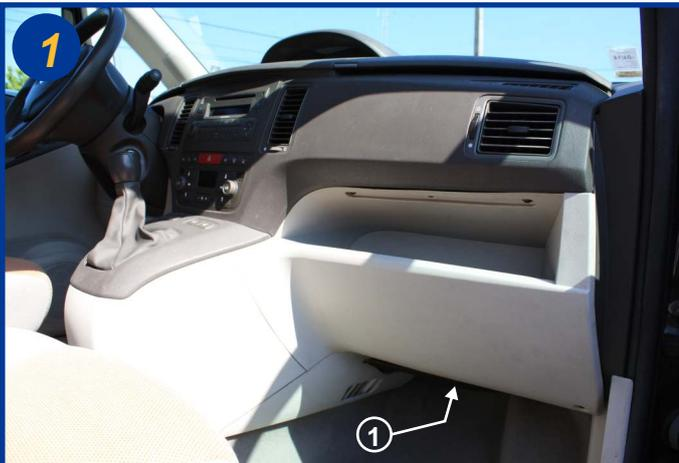
Le filtre d'habitacle est situé à l'intérieur du véhicule, côté passager sous la boîte à gants (1).
