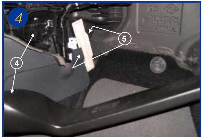
Déboîter la gaine de ventilation (voir flèche 4) . L'accès au boîtier filtrant est alors possible. Exercer une pression sur le couvercle de l'élément filtrant pour l'extraire (voir flèche 5) Le remontage s'effectue dans l'ordre inverse du démontage.
