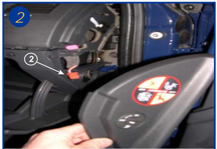
Déclipser le cache à droite sur lequel est situé la commande de verrouillage de l'air-bag passager et déconnecter la prise (voir flèche 2).
