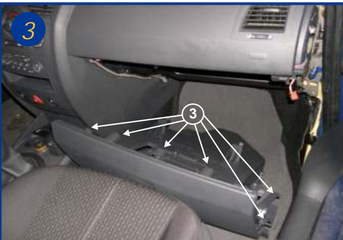
Dévisser les 6 vis Torx de maintien de la boîte à gants (flèches 3) et la retirer.
