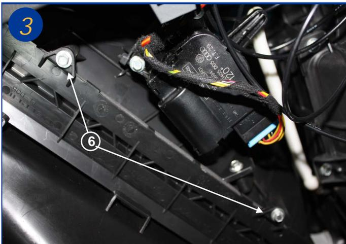
Dévisser les 2 vis de 5,5 mm de fermeture du boîtier filtrant (6).
