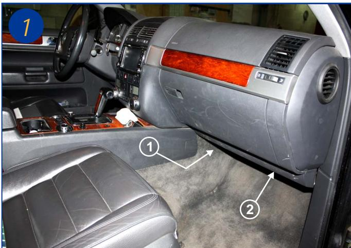
Le filtre d'habitacle est situé à l'intérieur du véhicule, côté conducteur sous la boîte à gants (1).
