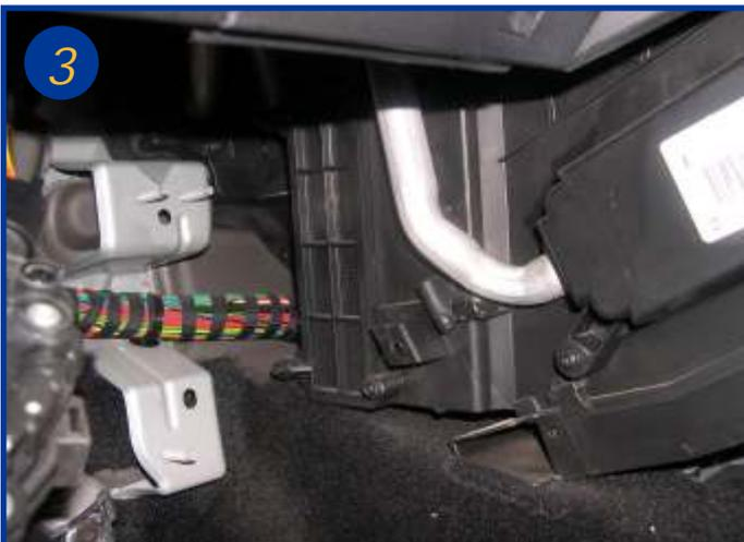
Retirer la petite vis plastique de maintien de la garniture de la console centrale.
