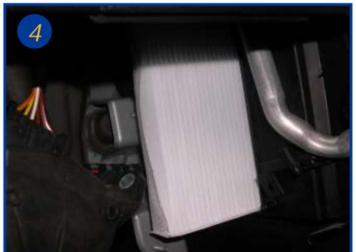
Retirer ensuite le couvercle du boîtier en dévissant ces 3 vis Torx de fixation. Sortir l'élément filtrant usagé en le faisant coulisser hors de son boîtier en le tordant légèrement. Le remontage s'effectue dans l'ordre inverse du démontage.
