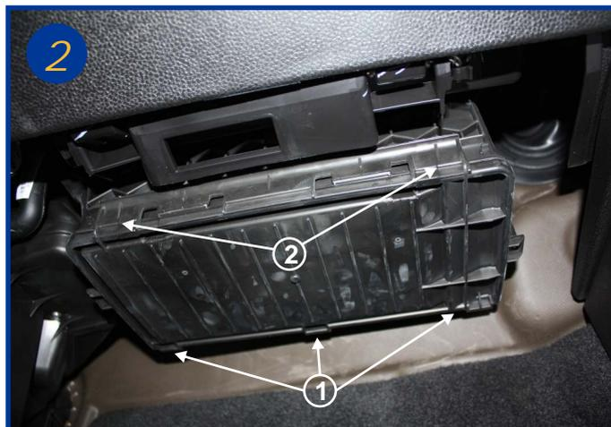
Agir sur les 2 fermetures (2) pour ouvrir le boîtier filtrant son couvercle possède une charnière en position arrière (3).
