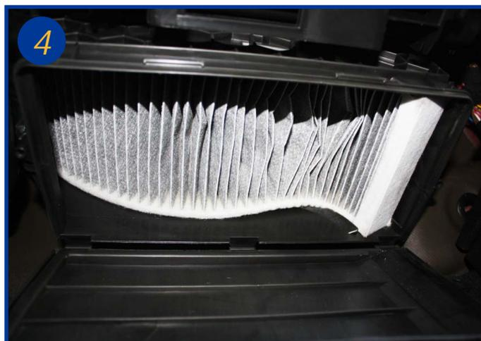
Procéder à son remplacement. Attention, il n'est pas aisé de replacer le filtre veiller à ce qu'il soit bien placé au dessus de la glissière. Le remontage s'effectue dans l'ordre inverse du démontage.
