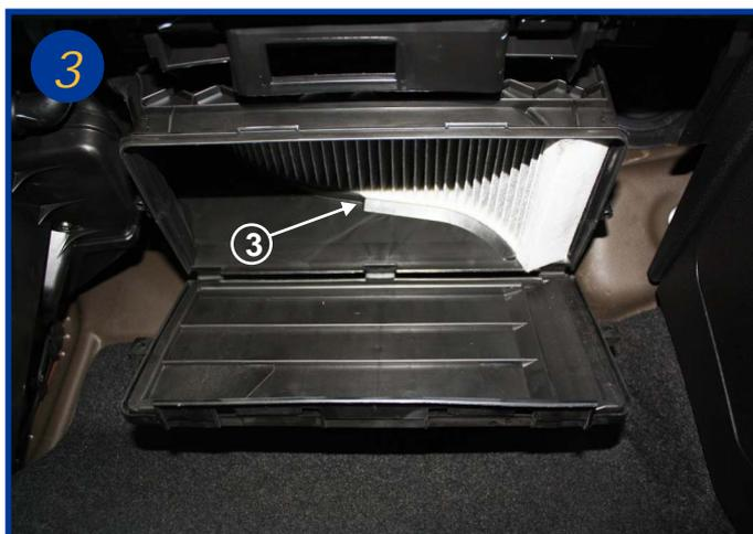
L'élément filtrant coulisse sur des glissières (3). Sortir l'élément filtrant usagé.
