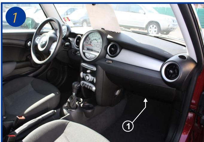
Le filtre d'habitacle est situé à l'intérieur du véhicule, côté passager sous la planche de bord (1).
