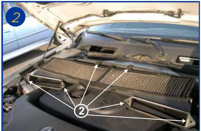
Dévisser les 6 vis de fixation du boîtier de filtre (repère 2), puis soulever l'ensemble et le retourner pour avoir accès au filtre
