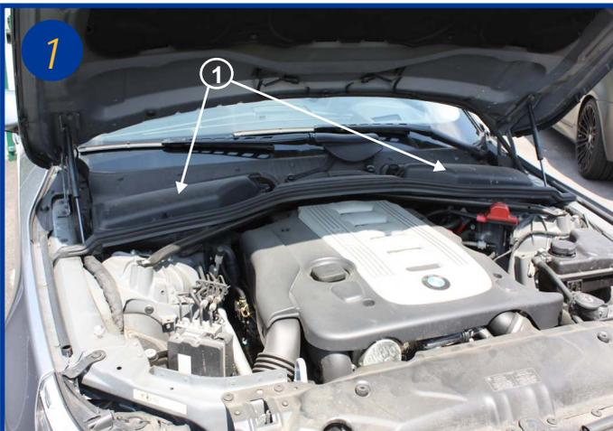
Les filtres d'habitacle sont situés sous le capot moteur sous la baie de pare-brise (1).
