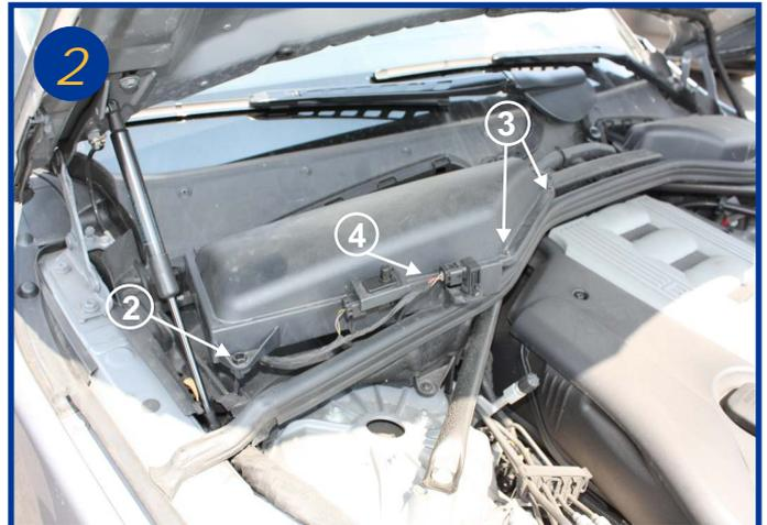
Dévisser d'un quart de tour l'écrou plastique (2) et basculer le fermetoir (3). Sortir le boîtier sans débrancher l'indicateur de colmatage (4).
