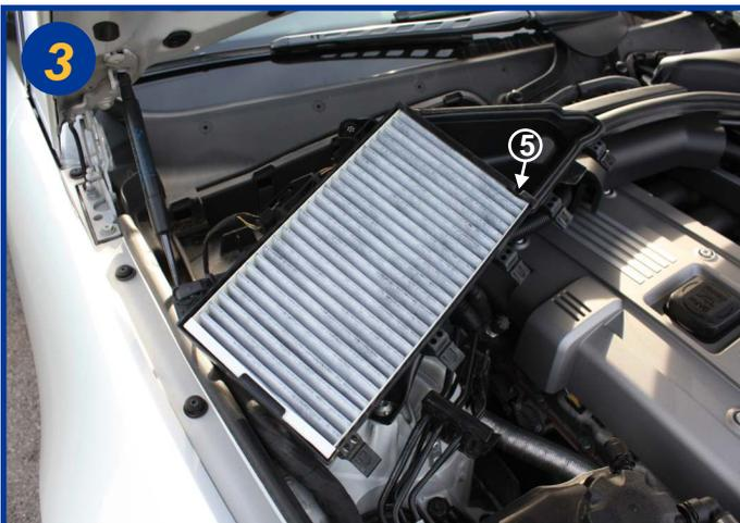
Retourner le boîtier et remplacer l'élément filtrant usagé, il y a un détrompeur sur le filtre et sur le boîtier filtrant afin de ne pas se tromper dans le sens du montage (5).
