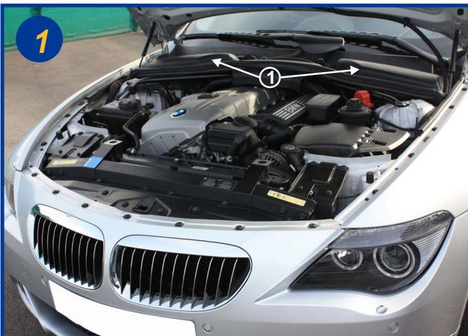
Les filtres d'habitacles sont au nombre de 2 situés sous le capot moteur devant la baie de pare-brise (1). Ouvrir le capot moteur.
