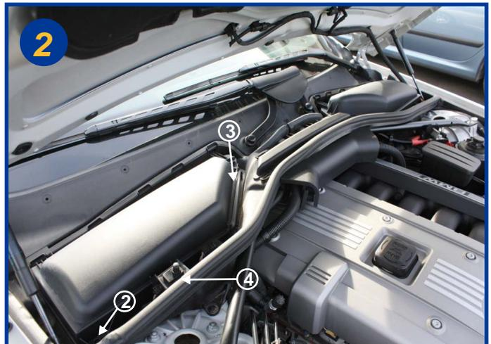
Dévisser d'un quart de tour l'écrou plastique (2) puis basculer l'agrafe métallique (3). Il n'est pas nécessaire de débrancher l'indicateur de colmatage situé de ce côté (4).
