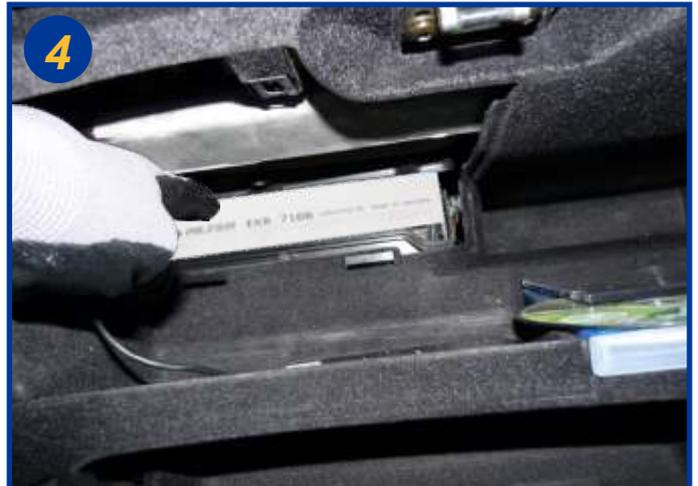
Extraire l'élément filtrant usagé et le remplacer.
