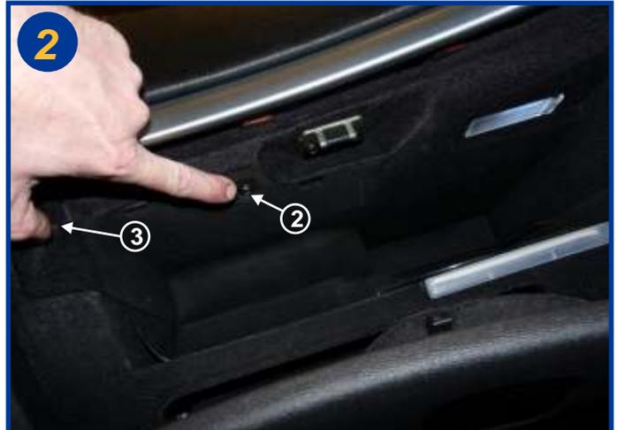
Pour atteindre le boîtier du filtre, dévisser la vis Torx (T20)(2) et retirer l'agrafe (3).
