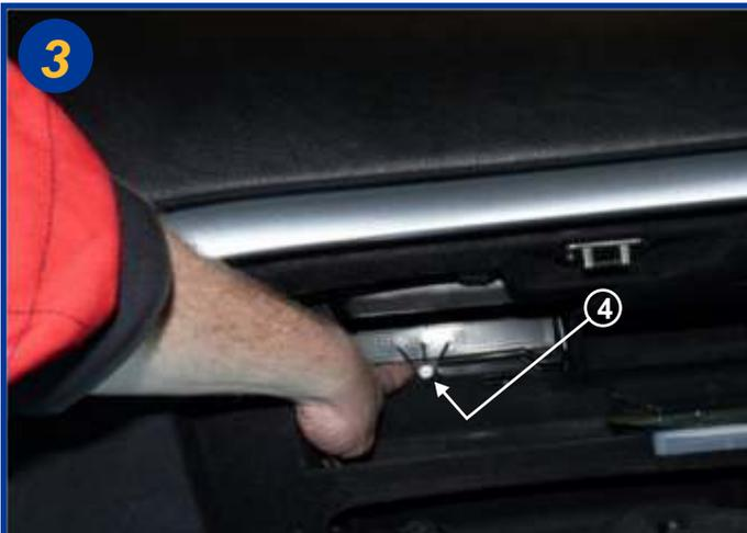
Dévisser la vis de 5,5 mm (4) et ouvrir le boîtier de filtre.
