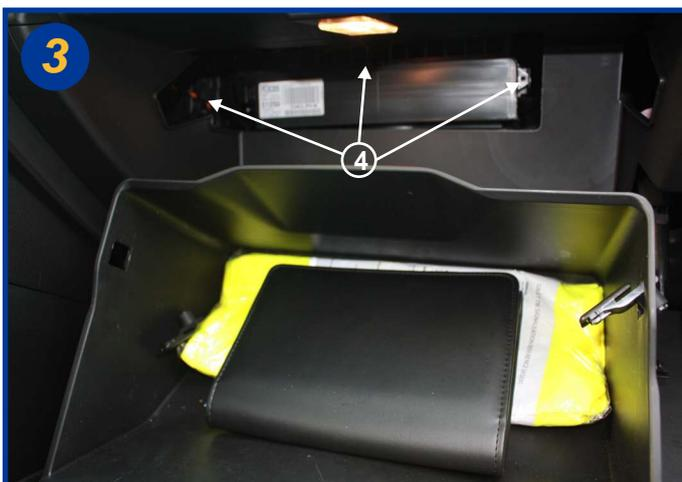
Ouvrir le boîtier filtrant en agissant sur les 3 pattes de fermeture (4), et basculer la trappe vers le bas.
