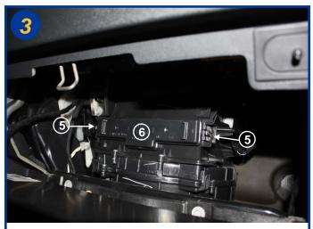
Agir sur les pattes de fermeture (5) aux 2 extrémités du couvercle du boîtier filtrant (6). Retirer celui-ci.
