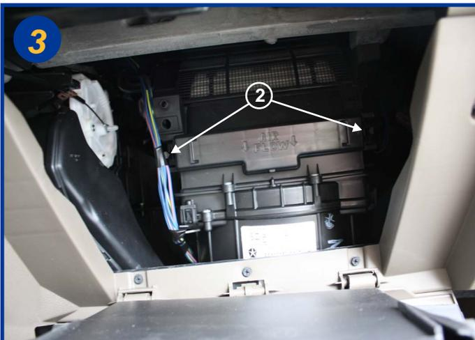
Appuyer sur les 2 ergots (2) et retirer le couvercle du boîtier filtrant.
