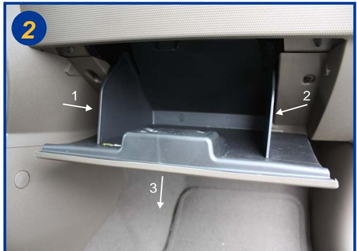
Ouvrir la boîte à gants, presser sur les flancs de côté pour dégager les arrêtoirs et basculer le tiroir vers le bas (voir flèches).
