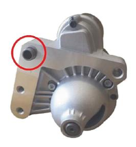
Ce démarreur doit être installé avec son pion de centrage (non fourni).
