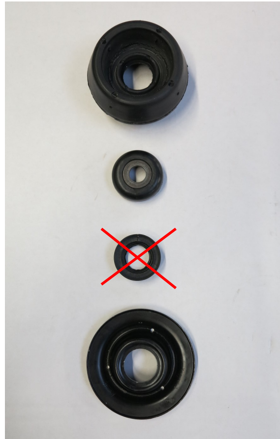
Abb. 2: Anordnung VA, Fig. 2: Arrangement FA, discard spacer
