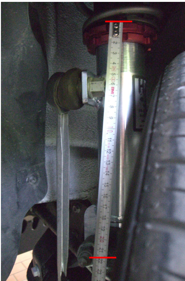
Abb. 3: Einstellmaß VA Fig. 3: Adjustment dimension FA
