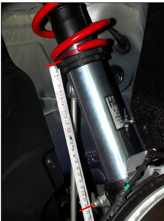
Abb. 4: Einstellmaß VA Fig. 4: FA spring plate adjustment dimension
