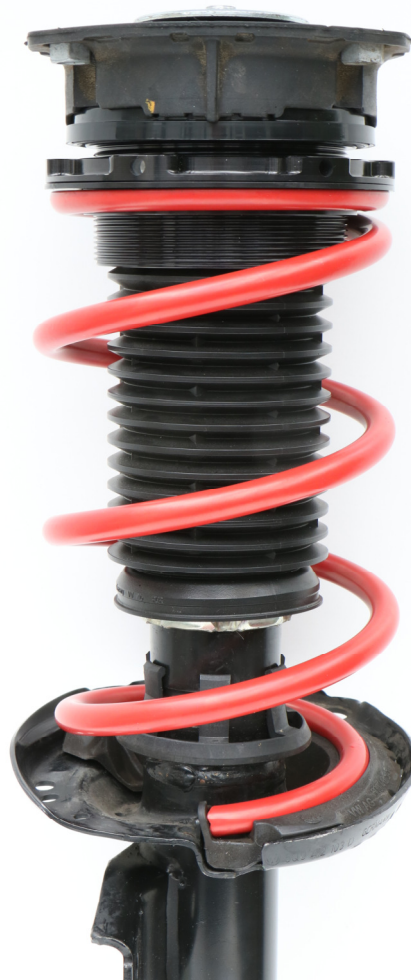
Abb. 6: Federbein komplett (Abbildung ähnlich) Fig. 6: Complete strut (Fig. may vary)
