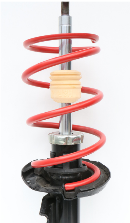
Abb. 2: Feder und Anschlagpuffer montieren Fig. 2: Mount the spring and bump stop
