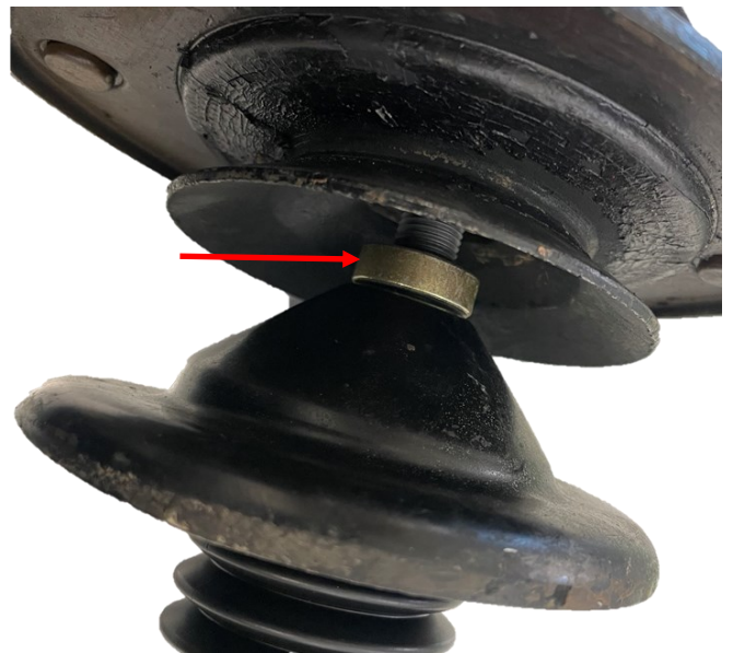
Abb. 3: VA Position dünne OE Scheibe
