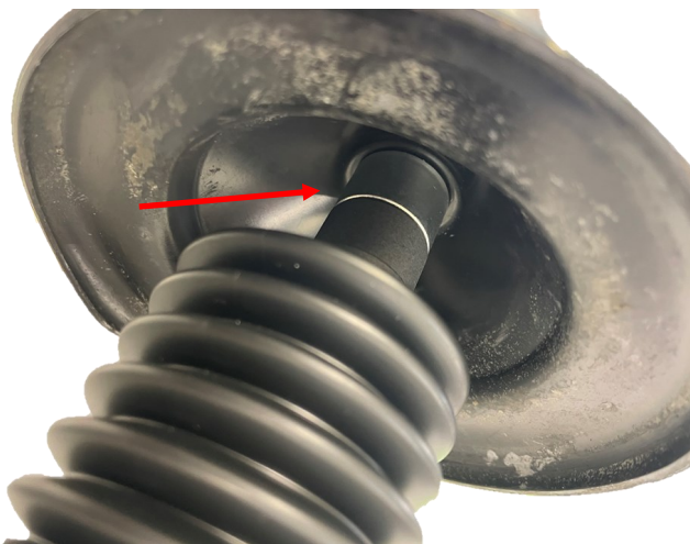
Abb. 2: VA Position dicke H&R Scheibe
