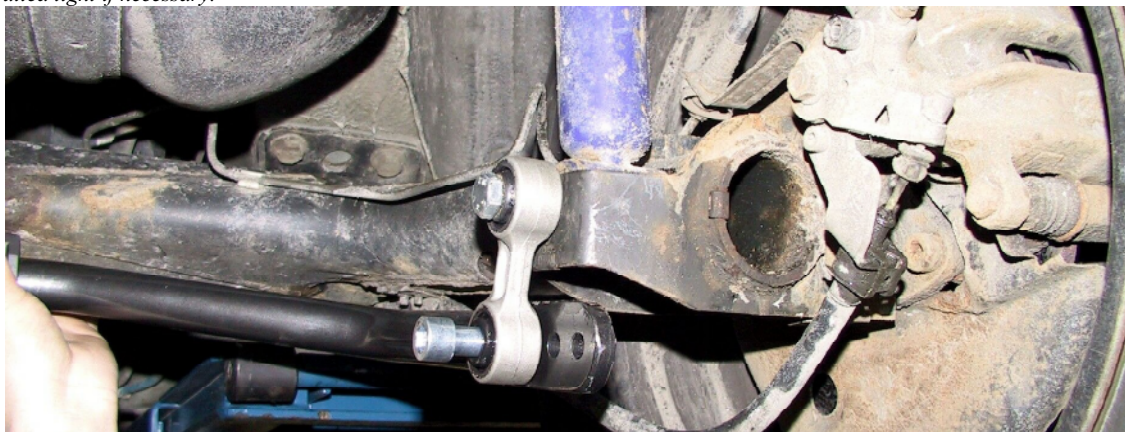
Abbildung/figure 5: Befestigung der Stabienden
