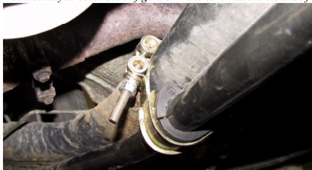
Abbildung/figure 3: Montage des Stabis
