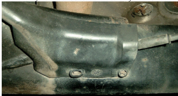
Abbildung/figure 1: Abdeckung des ABS Kabels
