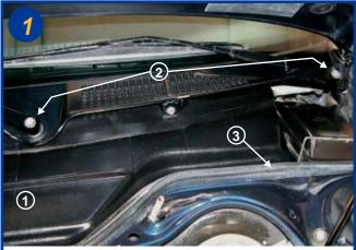
Le filtre d'habitacle est situé sous le capot moteur, coté passager sous la baie de pare-brise (1). Dévisser les 2 écrous de 13 (2) et extraire les essuies-glaces puis le joint d'étanchéité moteur (3).
