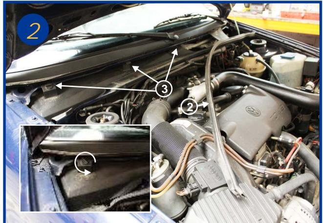
Retirer sur la moitié le joint d'étanchéité du compartiment moteur (2), puis dévisser d'un quart de tour les 3 loquets plastiques (3) (voir encadré).
