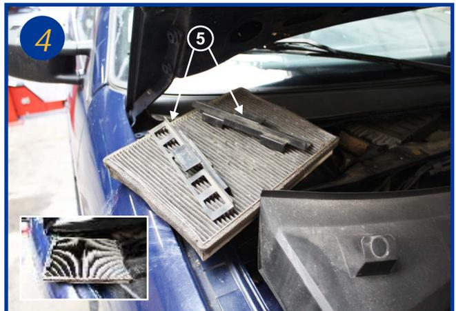
Retirer l'élément filtrant usagé, retirer également les 2 supports plastiques (5) et remplacer le filtre, replacer les supports comme (encadré) imbriqué dans le premier pli. Le remontage s'effectue dans l'ordre inverse du démontage.
