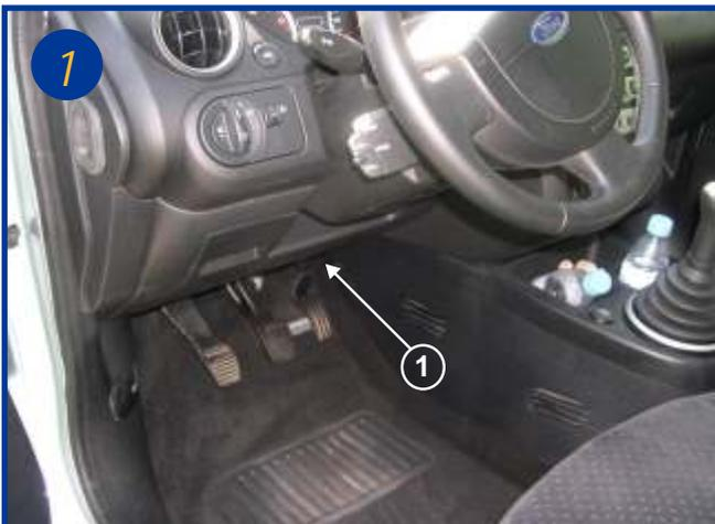
L'élément filtrant habitacle est situé coté conducteur à l'intérieur du véhicule à proximité de la pédale d'accélérateur (voir flèche 1).
