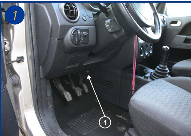
Le filtre d'habitacle est situé à l'intérieur du véhicule, côté conducteur à côté de la pédale d'accélérateur (1).
