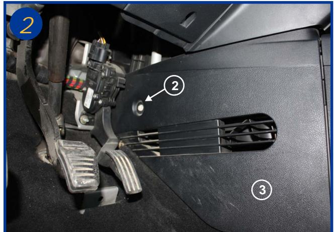
Retirer le clips plastique (2) et dégrafer la joue de la console centrale (3).
