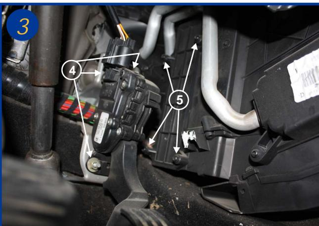
Dévisser les 3 écrous de 10 de fixation de la pédale d'accélérateur et la mettre de côté (4).
