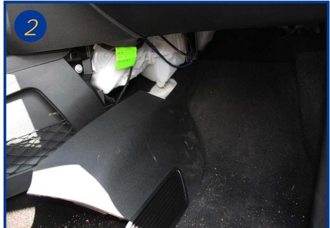
Dégrafer le flanc de la console centrale en tirant fortement et retirer ce carter dans sa totalité.
