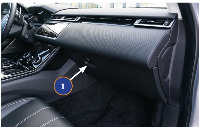
1. Le filtre d'habitacle est situé à l'intérieur du véhicule, côté passager sous la boîte à gants. Ouvrir la boîte à gants (1).
