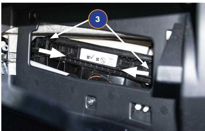
3. Ouvrir le boîtier filtrant en actionnant les tirettes (3) dans le sens des flèches à gauche et à droite du couvercle. Extraire le couvercle.
