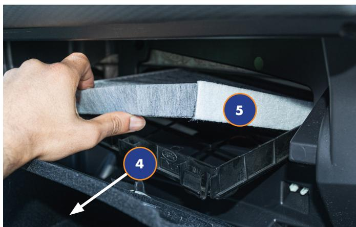
4. Sortir le tiroir de l'élément filtrant (4) et insérer un nouvel élément dans le logement (5). Le remontage s'effectue dans l'ordre inverse du démontage.
