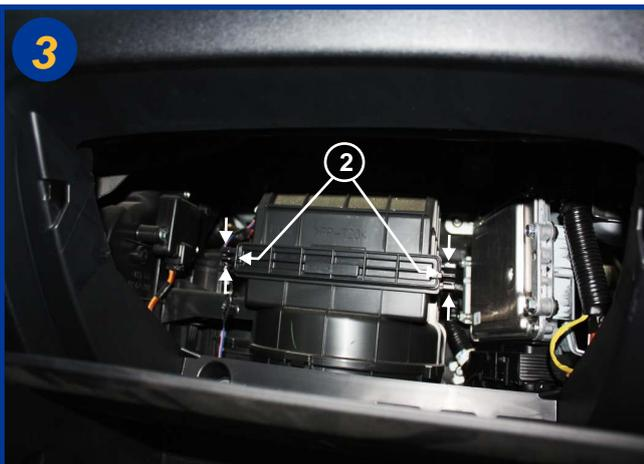
Appuyer sur les petites pattes aux 2 extrémités (2) du couvercle du boîtier filtrant dans le sens des flèches et retirer ce couvercle.
