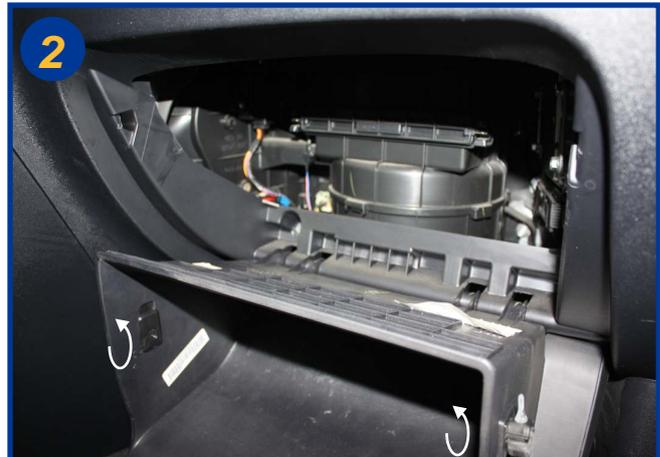
Actionner les arrêteurs dans le sens des flèches et basculer le tiroir de la boîte à gants vers le bas.
