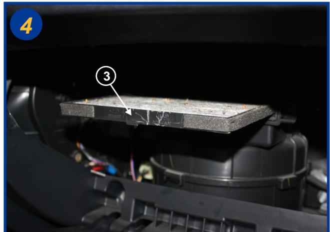
Extraire l'élément filtrant usagé en tirant sur la poignée (3) et procéder à son remplacement. Le remontage s'effectue dans l'ordre inverse du démontage.
