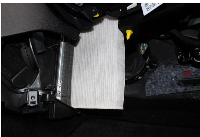
3. Ouvrir le boîtier filtrant en dévissant les quatre vis à tête hexagonale de 5,5 mm.
