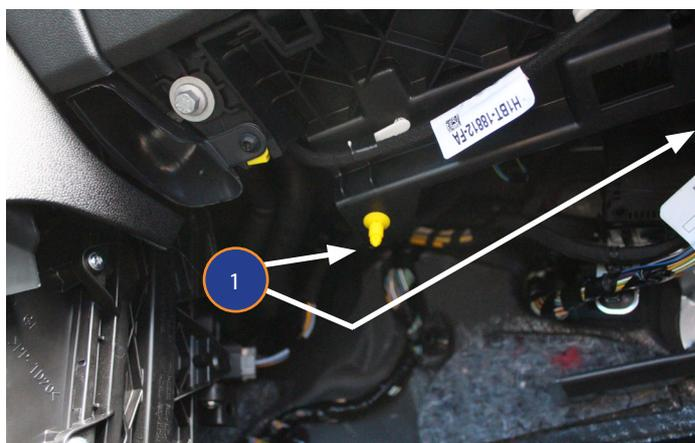
1. Le filtre d'habitacle est situé à l'intérieur du véhicule, côté passager, côté console centrale. Dévisser la vis située sur le flanc de la console après avoir retiré le petit cache en plastique (voir encadré).
