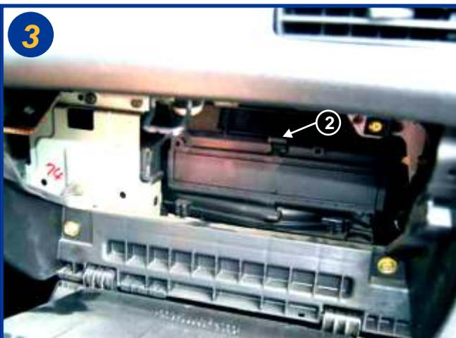
Ouvrir le boîtier filtrant en actionnant le fermoir vers le bas et le retirer (2).
