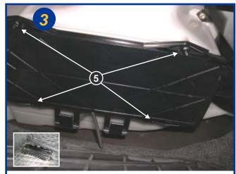
Dévisser les 4 vis Torx du couvercle du boitier filtrant (voir flèche 5) et retirer le couvercle (voir encadré).
