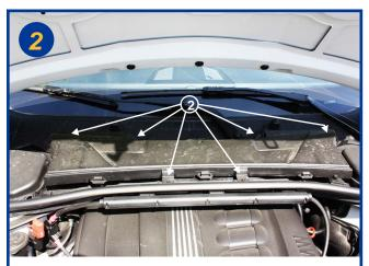
Dévisser les 6 vis de 8 du boîtier filtrant (2), le sortir et le retourner.
