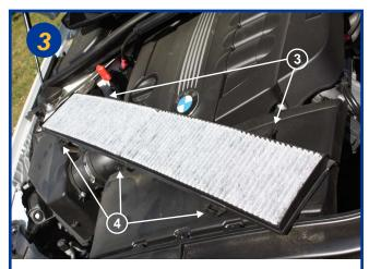
Extraire le filtre de son support, pour cela exercer une pression sur le filtre pour dégager les 2 ergots (3) et les 3 pattes (4).
