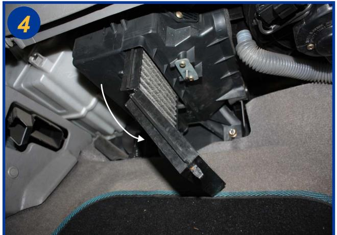
Replacer des éléments neuf (nota: ils sont articulés pour faciliter le montage)
