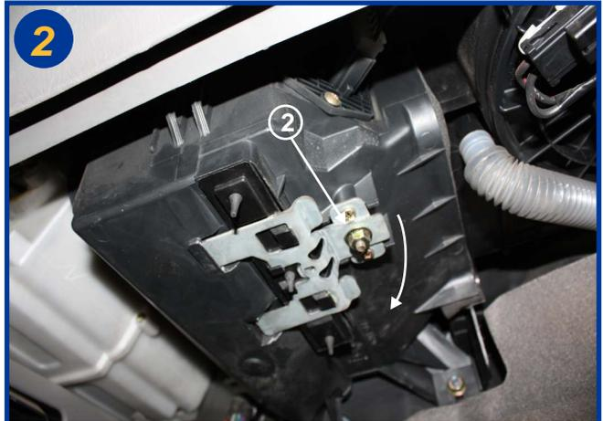
Dévisser l'écrou de 10 (2) et basculer la patte de fermeture du boîtier filtrant dans le sens de la flèche. Retirer le couvercle.
