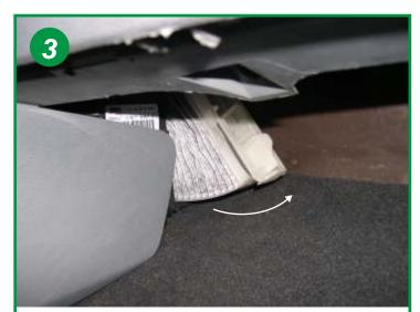
Le filtre est à extraire de la façon suivante, du bas vers le haut en le déformant dans le sens de la flèche.
