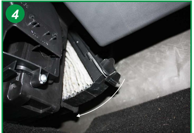
Procéder au remplacement du filtre, ré-introduire le nouvel élément en le déformant pour le faire rentrer (voir flèche).
