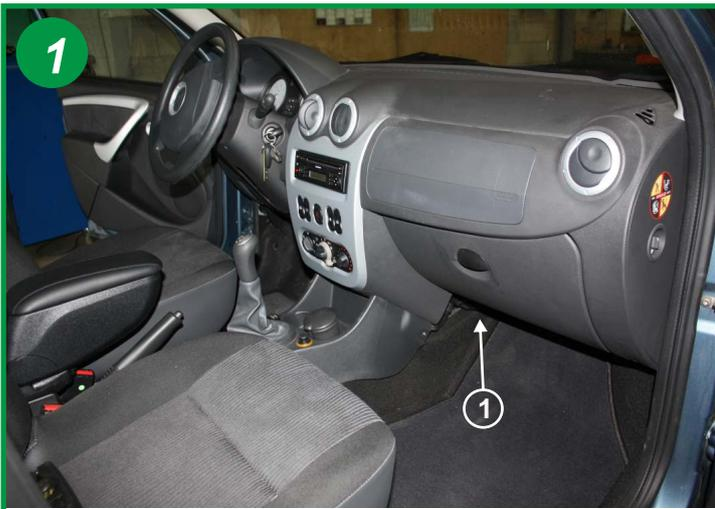
Le filtre d'habitacle est situé à l'intérieur du véhicule, côté passager sous la boîte à gants coté console centrale (1).
