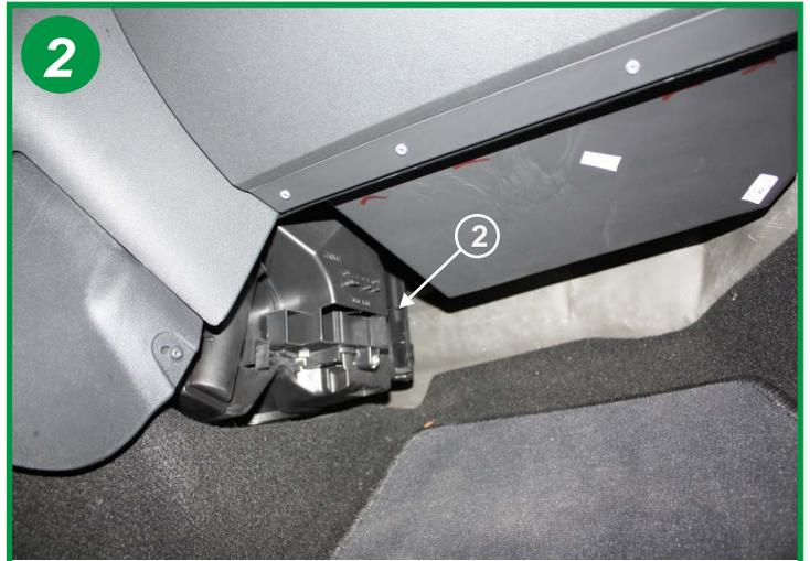
Détail du Climatiseur : le boîtier filtrant (2)
