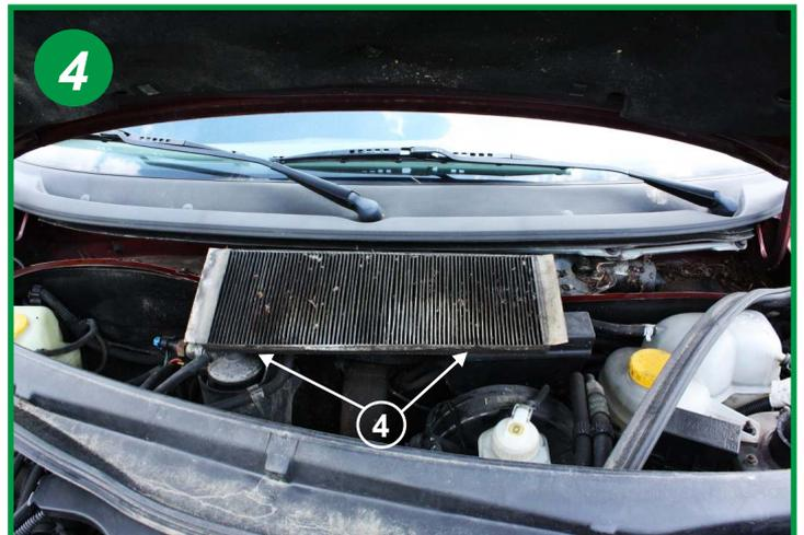
Basculer les 2 petits clips (4) et extraire le filtre usagé, une fois remplacé, le remontage s'effectue dans l'ordre inverse du démontage.
