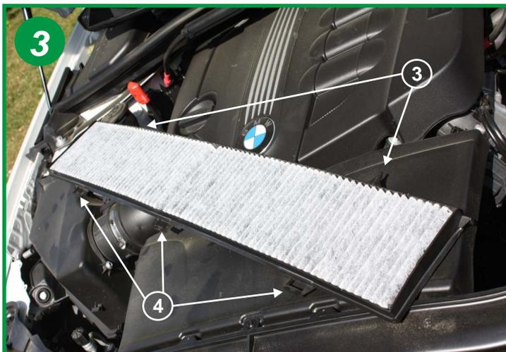
Extraire le filtre de son support, pour cela exercer une pression sur le filtre pour dégager les 2 ergots (3) et les 3 pattes (4).
