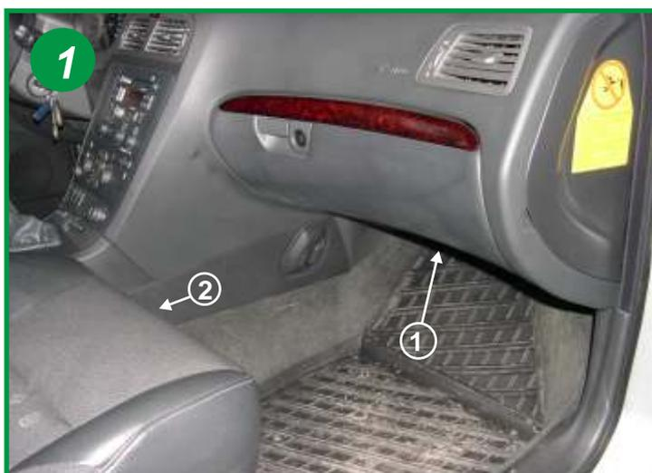
L'élément filtrant est situé dans l'habitacle du véhicule sous la boîte à gants (voir flèche 1).
