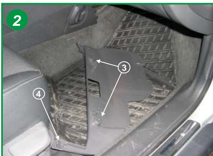
Dévisser les 2 vis torx (flèche 3) et déclipper le bord du cache plastique (voir flèche 4).
