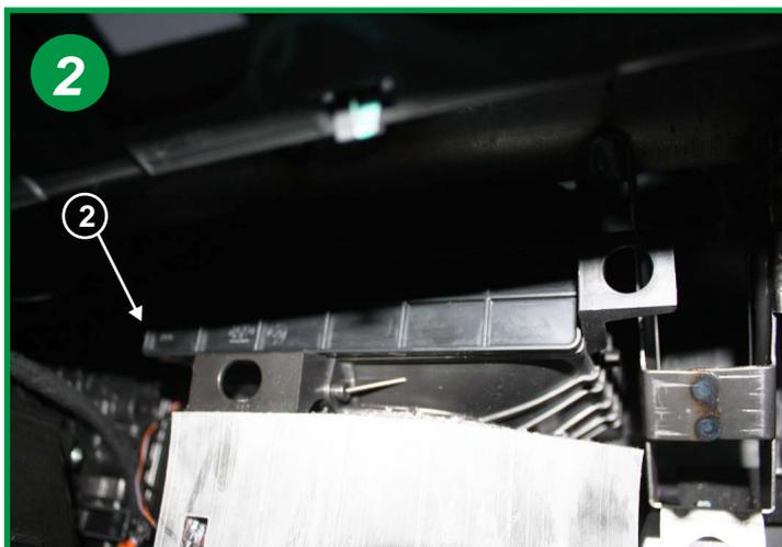
Ouvrir le boîtier filtrant par la gauche, une patte est prévue à cet effet (2) et retirer le couvercle.
