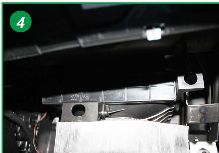
Une fois le nouveau filtre remis en place, refermer le couvercle du boîtier filtrant en le positionnant par la droite tout d'abord et en le cliquetant ensuite à gauche. Fermer la boîte à gants.
