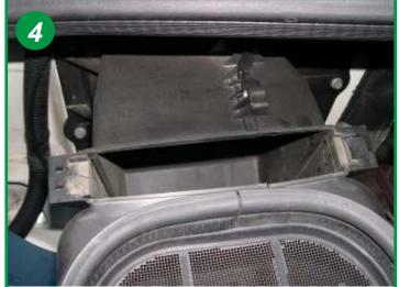
Extraire l'élément filtrant usagé en le tirant vers le haut. Le remontage s'effectue dans l'ordre inverse du démontage.
