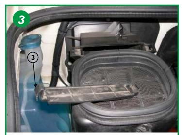
Retirer le couvercle du boitier filtrant en exerçant une pression sur la patte de fermeture (voir flèche 3).
