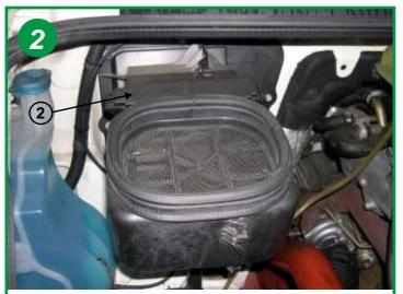
Le boitier filtrant se trouve juste derrière la bouche d'aération (voir flèche 2).
