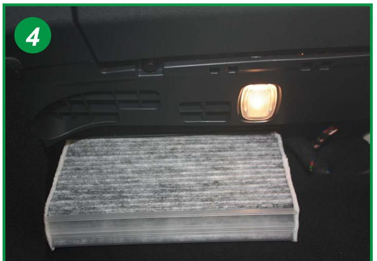
Extraire l'élément filtrant usagé avec un tournevis plat (difficulté de prise) et le remplacer. Le remontage s'effectue dans l'ordre inverse du démontage.
