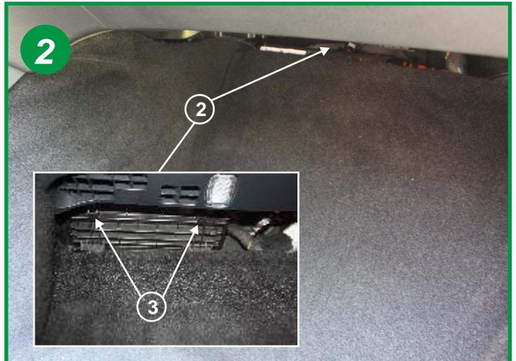
Sous la boîte à gants, localisation du boîtier filtrant (2). Appuyer fortement sur les 2 pattes (3) pour retirer le couvercle du boîtier
