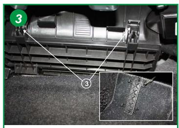
Pour retirer le couvercle du boîtier filtrant (encadré), faire levier sur les 2 pattes (3), baisser le couvercle vers le bas et l'enlever dans sa totalité.
